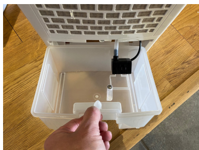
Steg 4. Nu är det bara att lyft bort vattenbehållaren.
